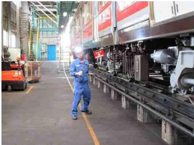
ハンマーを使います。ハンマーで「カン」と叩く音と、ハンマーに伝わる感触でネジの締め具合に問題がないかを確認します。音の高低によって瞬時に異常を判断するので、視覚だけでなく聴覚を使って些細な不具合を見つけ出すことができます。台車に関しても点検ハンマーを使って亀裂がないかの確認を行っています。私たちが毎日安全に電車に乗れるのは、このように日々の保守・点検を行い、常に正常な状態を維持しているからです。これらの点検を行う技術者は、先輩から後輩へ長年培ってきた高度で繊細な技術が安全の基盤となっています。
