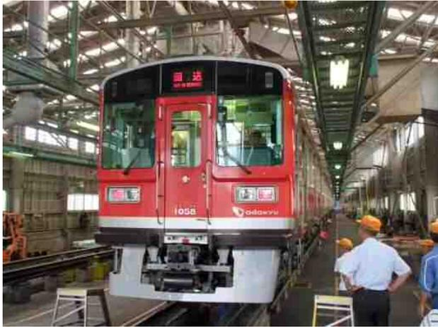
た。点検項目は各種保安装置（ATS、ATC等）パンタグラフ、ブレーキ、扉、制御装置などで、終日かけて行われる検査です。
