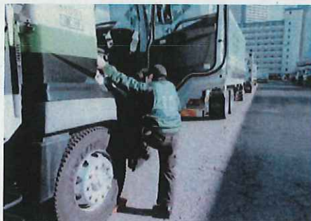
墜落・転落防止:三点支持の徹底
