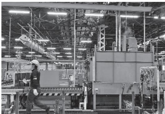
洗浄機排気蒸気による高湿度状態
