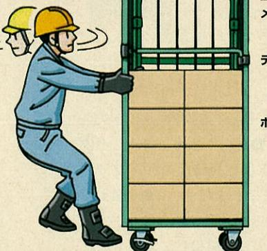
「よこ押し」は持ち手がないロールボックスパレットの構造を反映した操作方法です。ロールボックスパレットの重心に近い位置で操作するので操作性がよく、前方の見通しがよいこと等が特徴。
