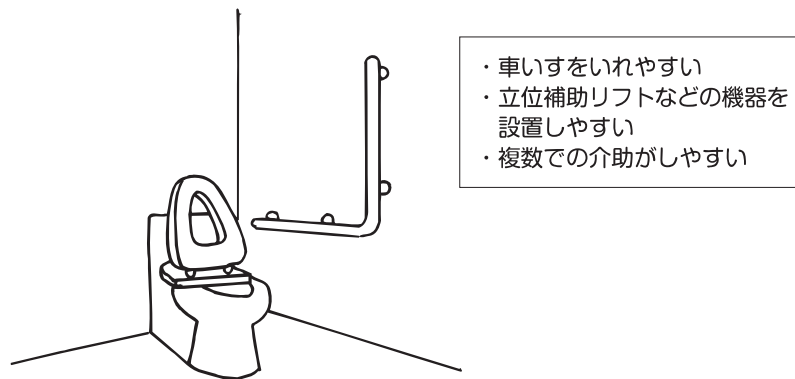
図6-2-15 広い空間が確保されたトイレ
