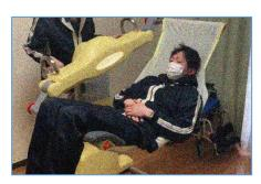
移乗介護ロボット ハンモックで身体を吊り上げ移乗 する介護ロボット
