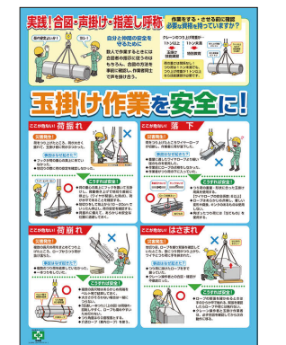
玉掛け作業を安全に No.589
