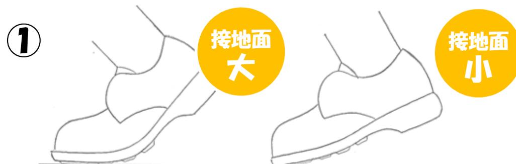
靴底の接地面積が大きくなり安定する。 靴底の接地面積が小さく不安定。
